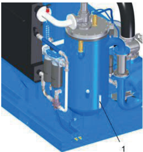
Рис. 31: Проверка уровня охлаждающей жидкости через смотровое стекло
